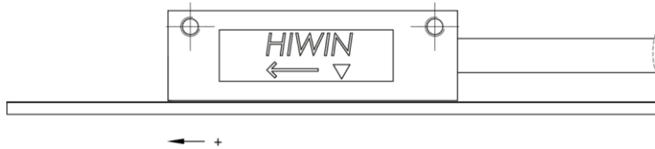
Abb. 6.138: Detailansicht positive Verfahrrichtung MAGIC-Lesekopf
