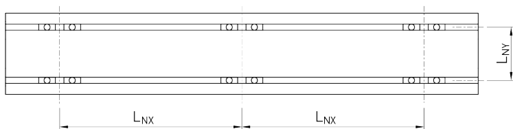
Fig. 6.24 : Fixation avec coulisseaux – HT200B
