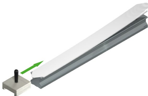
Rys. 4.10: Montaż taśmy osłonowej za pomocą narzędzia montażowego
